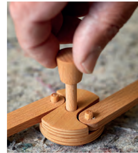
Ganz aus Holz: „Schubstangendrehschloss“ beim Kleiderschrank Tenso
